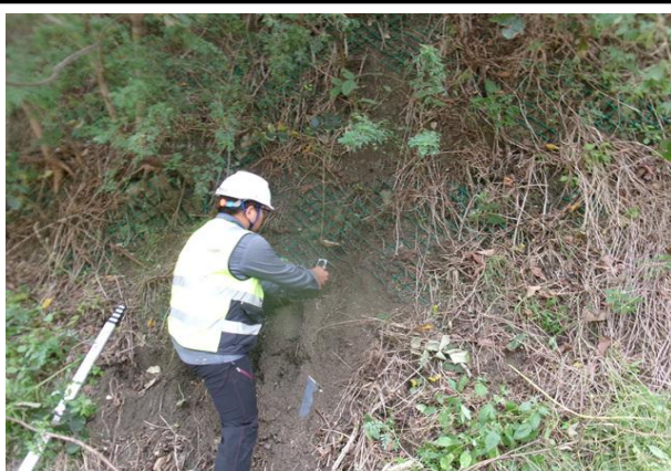
절리면 경사/경사방향 측정
